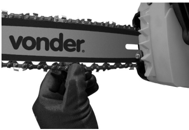
Fig. 6 – Ajuste de folga da corrente
