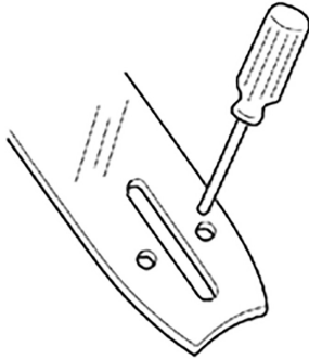
Fig. 28 – Limpieza del agujero de lubricación
