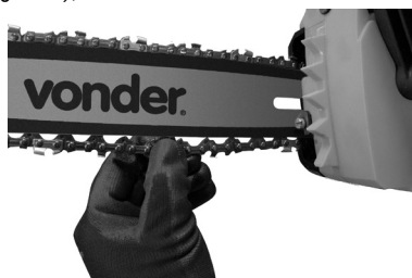
Fig. 6 – Ajuste de juego de la cadena
